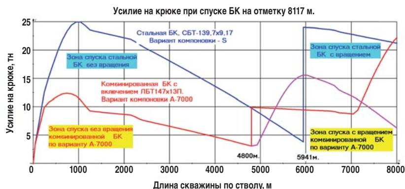
Рис. 8 Сравнительная динамика изменения усилия на крюке по глубине при спуске БК на проектную отметку 8117 м по вариантам компоновки А-7000 и S.
