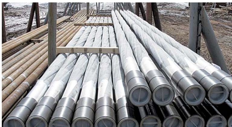
Рис. 5 Опытная партия ЛБТ 103x11С в ОАО «Татнефть».
